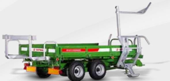
La remorque autochargeuse SIPMA WS 6510 DROMADER est une remorque à châssis bas dédiée au transport des balles d'une capacité de chargement de 6,5 tonnes. La pince latérale de la machine est glissée sous une balle et la ramasse sur la remorque. Ensuite, la balle est poussée par les bras spéciaux vers la partie arrière de la surface de transport afin de faire de la place pour les balles suivantes.
