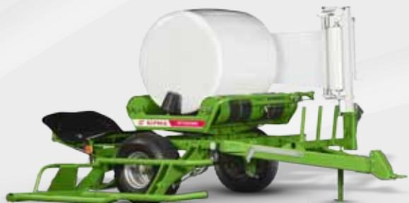
L'enrubanneuse autochargeuse SIPMA OS 7520 MIRA constitue une version plus économique, car elle est mécaniquement contrôlable par un distributeur de levier.
