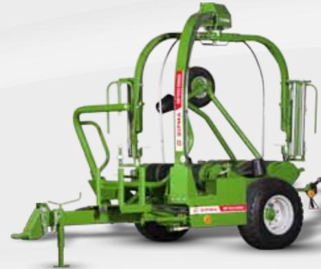
L'enrubanneuse SIPMA OR 7532 DIANA est une machine entièrement automatisée à chargement automatique. En plus de l'emballage conventionnel, il peut fonctionner dans le système 3D, ce qui permet de réduire la consommation du film d'environ 25%. L'ordinateur de bord vous permettra de programmer les paramètres du cycle d'emballage.
