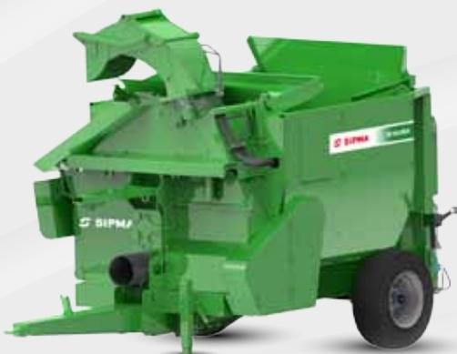
Le modèle SIPMA RB 1850 KRUK est une pailleuse pour la paille, le foin et l'ensilage de foin conçu pour les fermes d'élevage. La machine est également utilisée par les jardiniers et les producteurs de fruits pour étaler la paille entre les rangées de fraises, par exemple.
