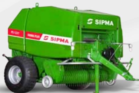
La presse SIPMA PS 1221 FARMA PLUS est équipée d'une chambre de roulement à chaîne à rouleaux. Il s'adresse particulièrement aux agriculteurs qui souhaitent obtenir un ensilage de haute qualité, mais il fonctionne également bien lors de la récolte de paille et de foin.
