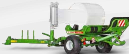
L'enrubanneuse autochargeuse SIPMA OS 7650 GAJA constitue une machine entièrement automatisée par un système de contrôle avancé qui permet de préprogrammer un cycle d'emballage.
