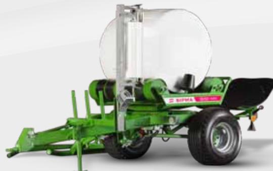
L'enrubanneuse équipée d'un dispositif de positionnement de balles SIPMA OS 7521 MIRA est une machine autochargeuse entièrement automatisée. L'automatisation complète de l'ensemble du processus est possible grâce à un système de commande avancé avec une option de programmation préalable des paramètres de travail.
